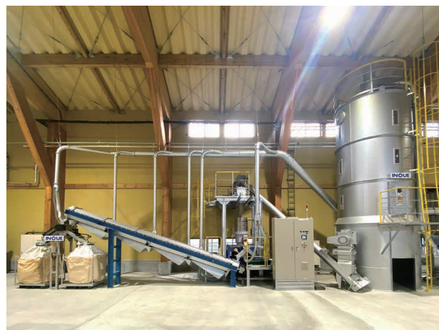
生産能力：350~500kg/h ペレット機：S75(55kw)
