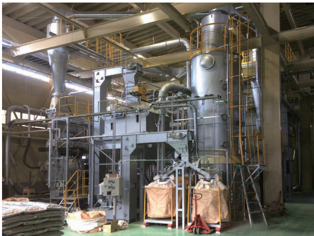
生産能力：3,000kg/h ペレット機：CPM(300kw)
