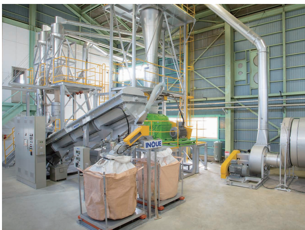
生産能力：500kg/h×2 ペレット機：S75×2式(55kw×2)
