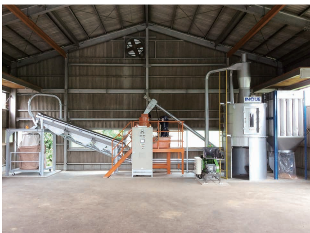
生産能力：150kg/h ペレット機：PT2242(22kw)
