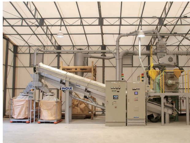
生産能力：1,000kg/h ペレット機：SPM500(55kw×2)
