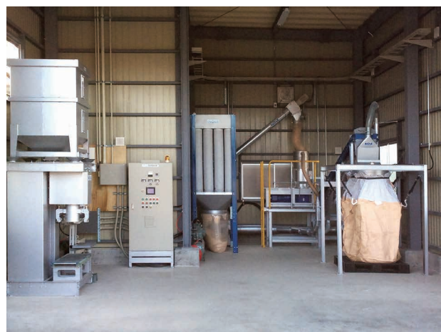
生産能力：50~100kg/h ペレット機：S15(11kw)
