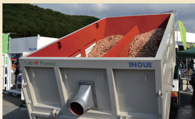
乾燥用温風の給気口と乾燥機構
