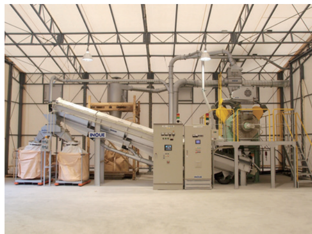
生産能力：1,000kg/h ペレットサ－：SPM500(55kw×2)
