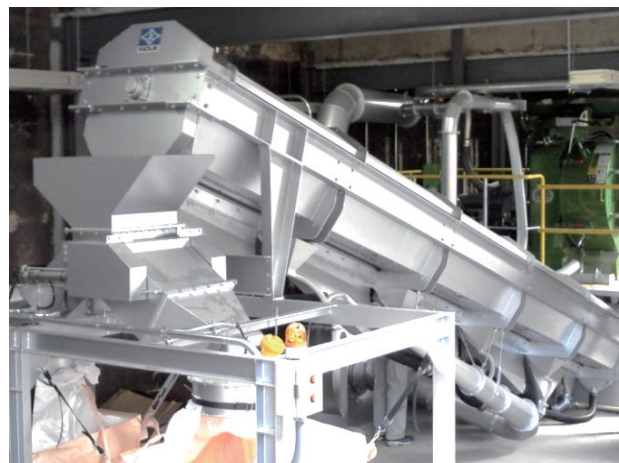
生産能力：1,000kg/h ペレットサ－：CPM3000(90kw)
