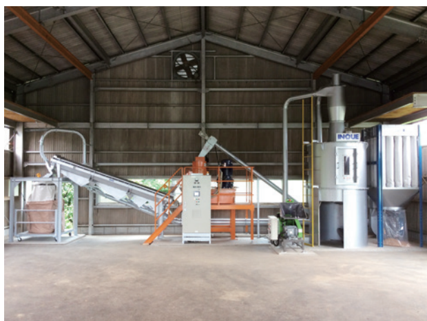
生産能力：150kg/h ペレットサ－：PT2242(22kw)
