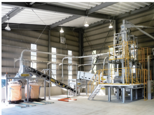
生産能力：1,000kg/h ペレットサ－：TS450×2基(45kw×2)
