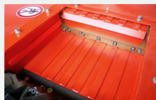
四面セグメントフロア(オプション) 薄い破砕物のラム四面での噛み込み防止
