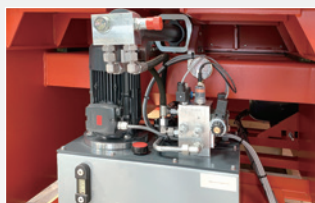
油圧ポンプ/シリンダー ラムをロータの負荷と連動して前進後退 高速後退機能付
