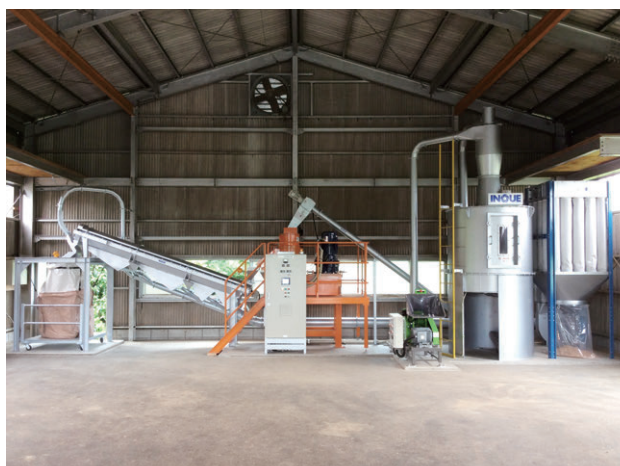
生産能力：150kg/h ペレットサイザー：PT2242(22kw)
