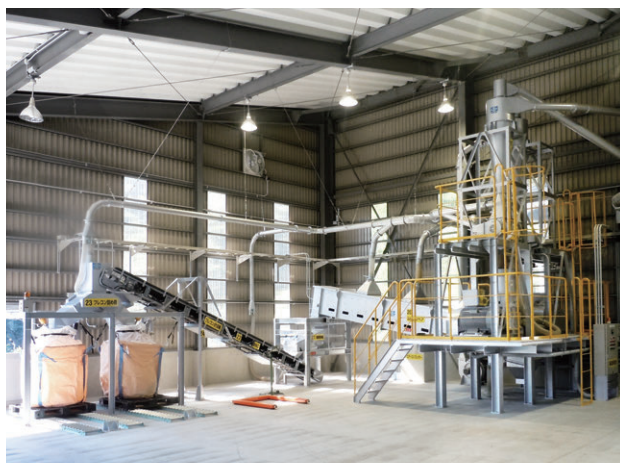
生産能力：1,000kg/h ペレットサイザー：TS450×2基(45kw×2)
