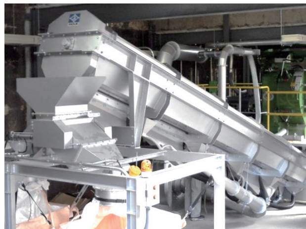
生産能力：1,000kg/h ペレットサイザー：CPM3000(90kw)
