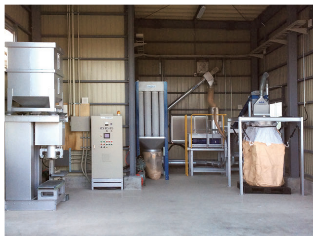
生産能力：50～100kg/h ペレットサイザー：S15(11kw)
