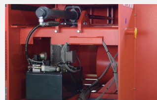
油圧ポンプ/シリンダー ラムをロータの負荷と連動して前進し、後退
