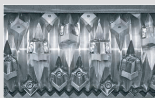
Vロータ/固定刃 凹面カッタ40mm角は4コーナ使用可能
