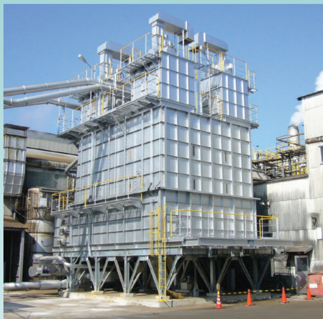
SRR6W3 : 350m³ バグフィルター集塵機付
